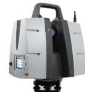
Velocità di scansione: 1.000.000 punti/sec - Precisione misura della distanza: 0.7 mm - Precisione angolare: 3.7" orizzontale, 5.0" verticale - Rumore: 0.5mm a 50 m (certificato di calibrazione 08/01/2019)
